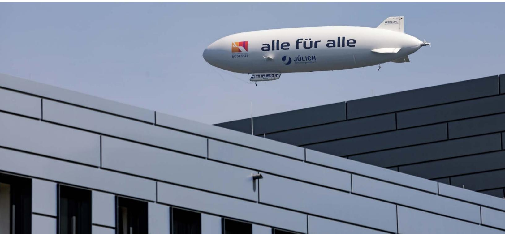
Mithilfe eines Zeppelins misst das Forschungszentrum Jülich die Konzentration von Treibhausgasen in der Atmosphäre.
