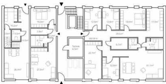
Möglicher Grundriss Regelgeschoss Geschosswohnungsbau
